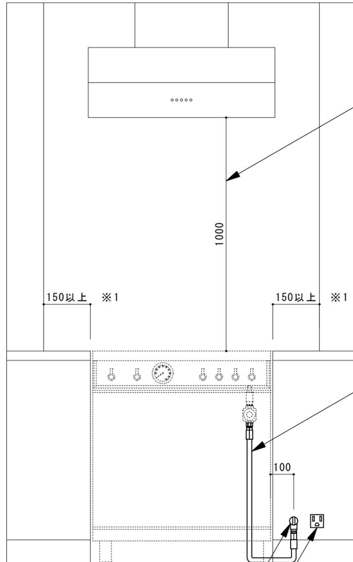
火源よりH=1000mmとしてその他設置に関しては消防法を確認し基準に則った設置をして下さい。
